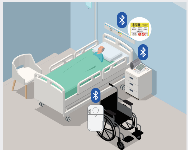
BLE 내장 디스플레이를 IoT 게이트웨이로 활용
